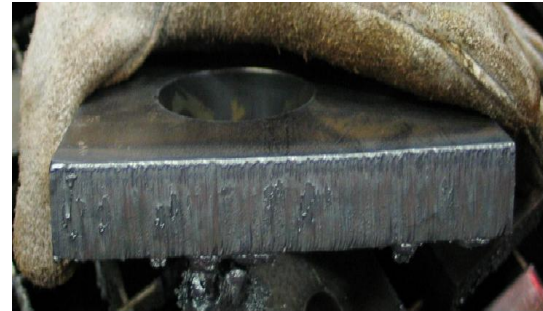
Suprafața tăiată cu oxigaz este rugoasă și prezintă formațiuni de zgură
