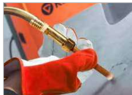
Funcția HotSpot™ face contractia metalului și încălzirea componentelor simple și convenabile.
