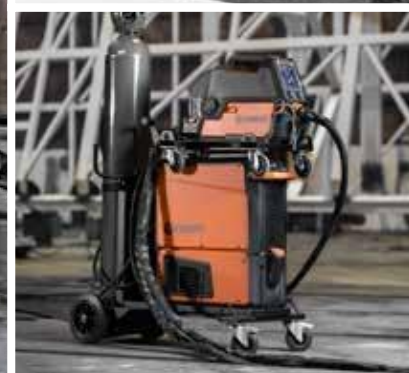
Căruciorul pentru derulatorul de sârmă cu patru roți are un design conceput pentru o conexiune rapidă, permițând andocarea ușoară cu sursele de alimentare standard X5 FastMig, oferind astfel depozitare și transport sigur la nivelul solului.
